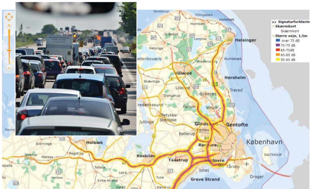
Figur 2. Eksempel på strategiske støjkort for større veje for den nordlige del af Sjælland – daglige værdier.
